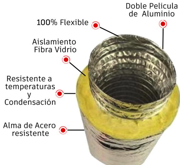
“El ducto flexible, **DUCTOFLEX**, con o sin aislamiento en fibra de vidrio para aplicaciones de aire acondicionado y ventilación. Conformado por un núcleo de alambre helicoidal de acero encapsulado entre dos películas de poliéster, a través de cual fluye el aire del sistema.”
