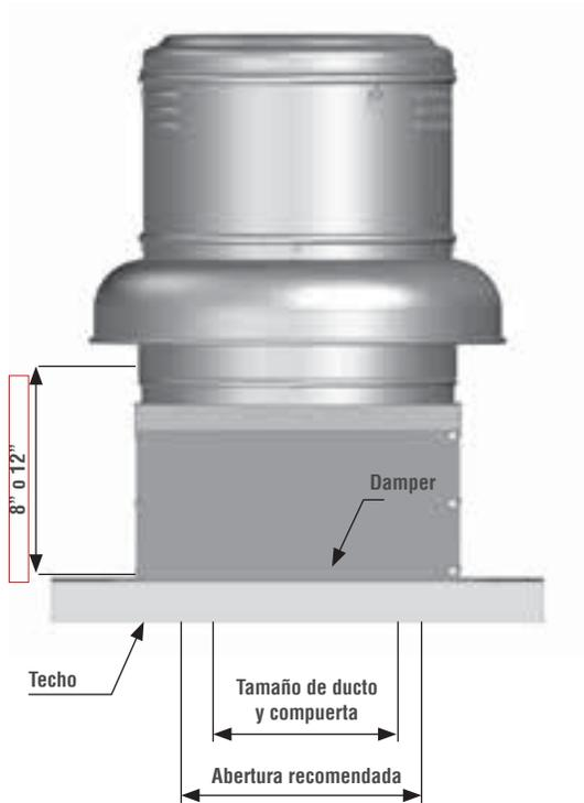
1. La fijación del extractor al techo, deberá hacerse con una base especial para montaje (Ej. Roof) con el fin de que la embocadura quede firme en la instalación. Como accesorio se puede utilizar un Damper o persiana.
